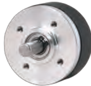
M6 - 0.6875" Dia. Boss M3x0.5-6H 0.187" Deep 4x1.000" BC Dynapar E23 Tekel TK-15
